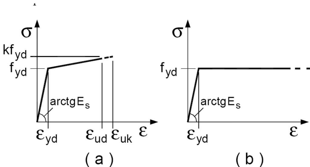
Figura 4.1.2– Modelli  $\sigma$ - $\epsilon$  per l'acciaio
